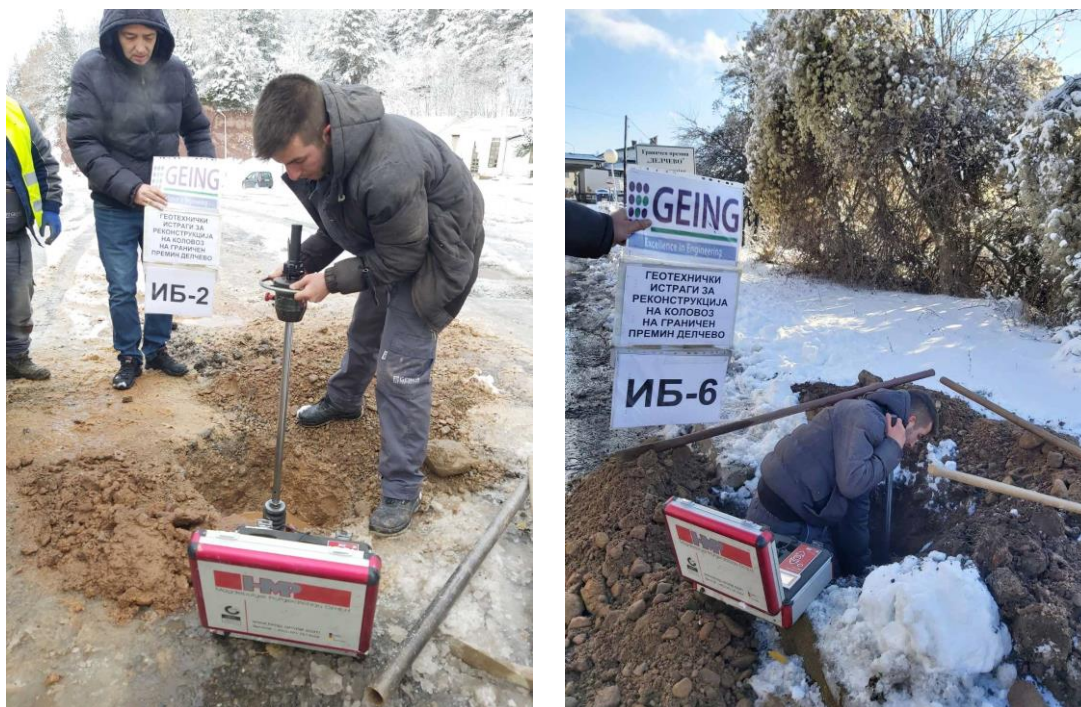
Слика бр. 1. Определување модул на стисливост со динамичка кружна плоча
